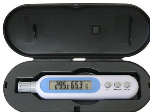
Grâce à sa tête rotative ajourée, il permet de déterminer la température ressentie au vent (windchill) ou le refroidissement éolien.
